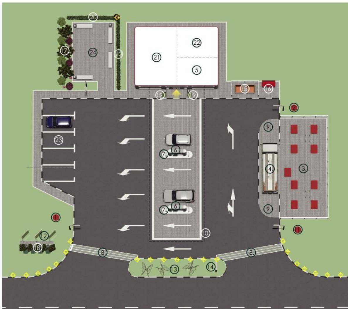
Тип 1.2. Схема планировочной организации придорожной автомобильно-заправочной станции
